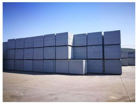
加气砖是一种轻质、多孔的新型建筑材料,具有质量轻、保温好、可加工和不燃烧等优点。以硅质材料(砂、粉煤灰及含硅尾矿等)和钙质材料(石灰、水泥)为主要原料,掺加发气剂(铝粉),通过配料、搅拌、浇注、预养、切割、蒸压、养护等工艺过程制成的轻质多孔硅酸盐制品。基本材料(1)粉煤灰:粉煤灰在加气混凝土中的作用主要是提供SiO2□同时,其中的Al2O3也具有较大作用(特别是在浇注以后的静停过程中)。(2)石灰:石灰是石灰石经高温煅烧,分解释放出CO2□但尚未达到烧结状态的白色块状物。(3)水泥:水泥是一种广使用的水硬性胶凝材料,品种很多,适用于加气混凝土的是硅酸盐水泥。(4)砂:砂是加气混凝土工业广采用的硅质材料,在加气混凝土中的作用主要是提供SiO2□按孔洞率分:实心砖、多孔砖。南安轻质加气砖多少钱
